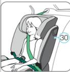
2. Placez le siège auto sur un siège du véhicule dont l'utilisation est autorisée en l'orientant vers la route. Veillez à ce que le dossier 30 repose à plat sur le dossier du siège du véhicule.
