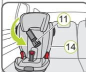
6. Placez le XP-PAD (11) sur le côté le plus proche des portes du véhicule dans le siège enfant.
