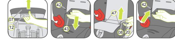
4. Heben Sie in den Verstellgriff **12** an der Rückseite der Kopfstütze **07** und drücken Sie die Kopfstütze in die unterste Position.
