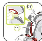
Eine richtig eingestellte Kopfstütze (07) gewährleistet den optimalen Verlauf des Diagonalgurts (11), und bietet Ihrem Kind optimalen Schutz. Die Kopfstütze (07) muss so eingestellt sein, dass zwischen den Schultern Ihres Kindes und der Kopfstütze (07) noch zwei Finger breit Platz ist.
