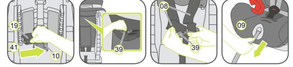
17. Ziehen Sie die Gurtschlaufen der Schulterpolster **19** über die Kunststoffstege **41** des Schultergurthöhenverstellers **10**. Tipp: Die Gurtschlaufen der Schulterpolster sollten die untere Schlaufe sein.
