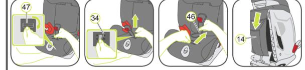
1. Greifen Sie von unten die SecureGuard-Metallplatte und **47** drehen Sie sie in eine senkrechte Stellung.
