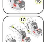
9. Nehmen Sie den Top Tether (13) und drücken Sie die Metallzunge (16) vom Gurt weg, um den Gurt zu verlängern, und ziehen Sie den Top Tether (13) am Schnapphaken (17), bis er V-förmig ist.
